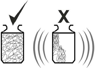
**3** **CAUTION:** EVENLY DISTRIBUTE WET WASHING IN THE SPIN DRUM. AN OUT OF BALANCE LOAD COULD DAMAGE THE SPIN TUB
