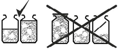
**2** FAILING TO PLACE THE DISK COVER INTO THE SPIN DRUM COULD CAUSE THE CLOTHING TO RISE OUT OF AND GET ENTANGLED ROUND THE DRUM
