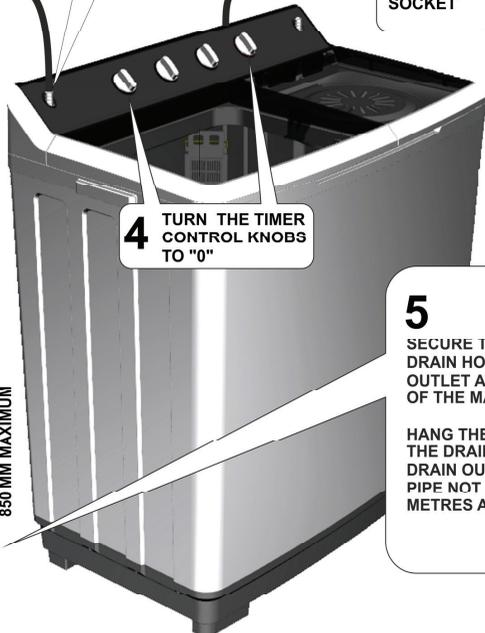
**5** SECURE THE END OF THE DRAIN HOSE OVER THE PUMP OUTLET AT THE LOWER BACK OF THE MACHINE.
