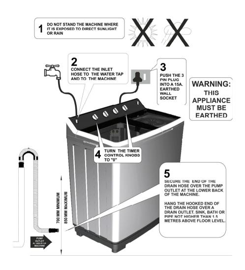
THE MACHINE MUST STAND ON A LEVEL SURFACE
